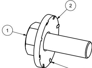
BE SURE TEETH ON THE CONICAL WASHERS ARE AGAINST THE HITCH
